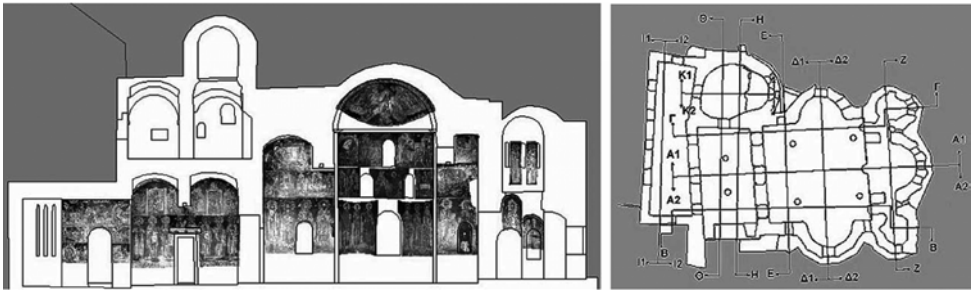
Εικόνα 14. Αρχιτεκτονικά σχέδια, τομές και φωτογραφίες χρησιμοποιήθηκαν για τη τρισδιάστατη αναδημιουργία και τη ρεαλιστική αναπαράσταση της κεντρικής εκκλησίας.
