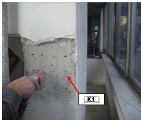
Κάθεται στην μικρή πλευρά του στύλου Κ9 με δώδεκα (12) συνολικά πιέες
