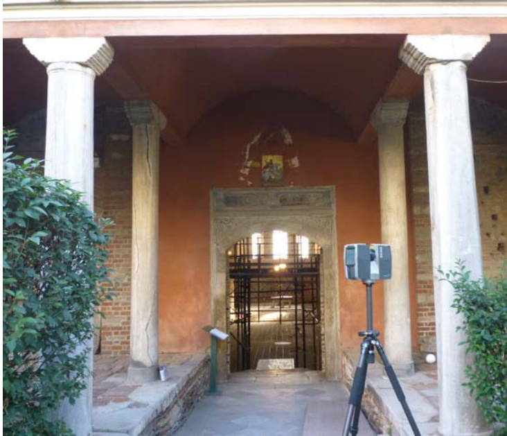
Εικόνα 4. Το Laser Scanner Faro Gocus 3D στην είσοδο της Ροτόντας
